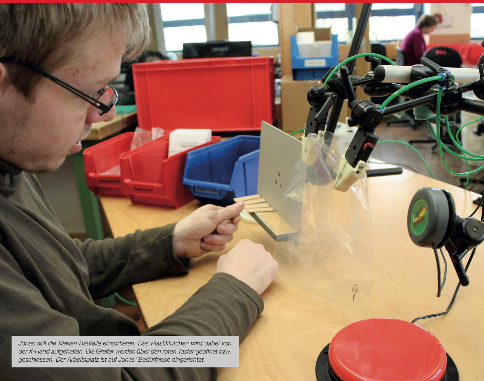
*Jonas soll die kleinen Bauteile einsortieren. Das Plastiktütchen wird dabei von der X-Hand aufgehalten. Die Greifer werden über den roten Taster geöffnet bzw. geschlossen. Der Arbeitsplatz ist auf Jonas' Bedürfnisse eingerichtet.*
